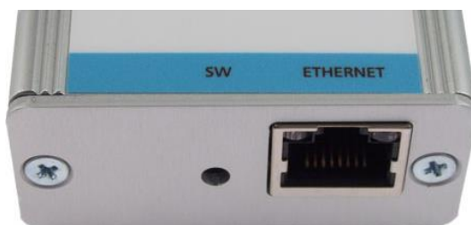
obr. 5 - HART ETH : tlačítko reset a konektor pro připojení k počítačové síti
