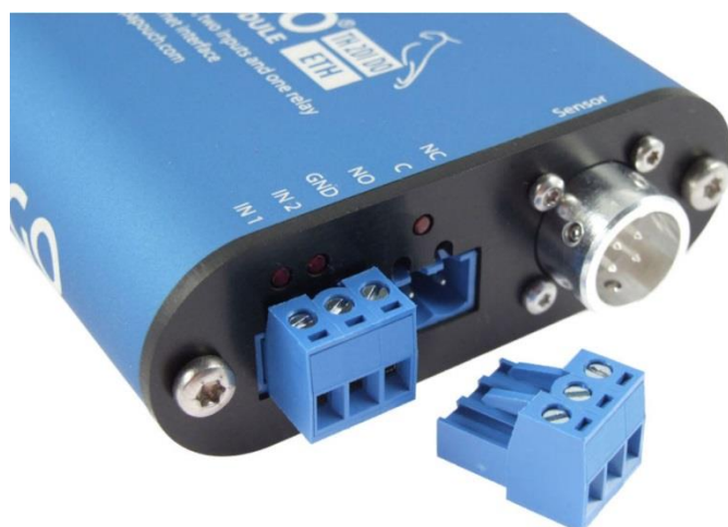
obr. 2 – čelo s konektorem a svorkami pro připojení vstupů, relé a senzoru
